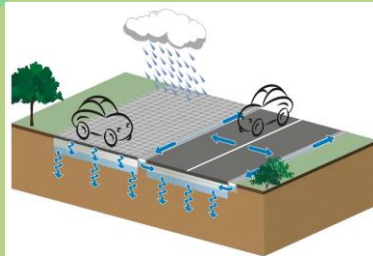
Revêtements perméables Structures réservoirs
