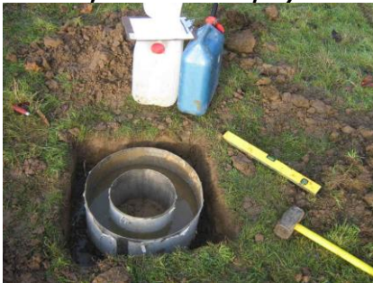
Evaluation de la perméabilité du sol: test du double-anneau – Photos : ARIES, 2010 + SGS
