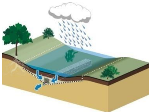
Noue de rétention et de dépollution
