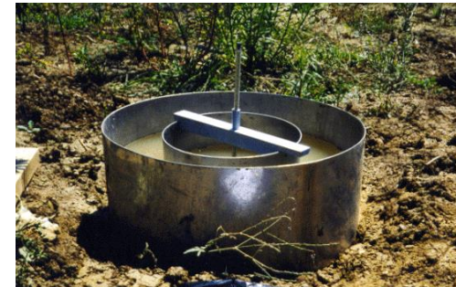
Evaluation de la perméabilité du sol: test du double-anneau – Photos : ARIES, 2010 + SGS
