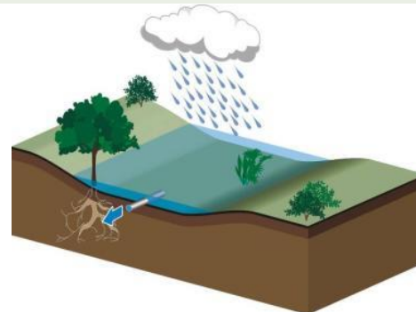
Sol imperméable : Noue à évacuation superficielle
